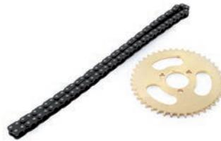
Das Tuning Set macht den Scooter gute 5 km/h schneller Zahnrad mit 44 Zähnen / Wirkdurchmesser Ø 110 mm Mittelbohrung Ø 30 mm, gekürzte dicke Kette mit 39 Gliedern, ca. 10 mm breit. Achtung: beim Modell SXT 500 EEC muss das Motorritzel auch mit gewechselt werden!
