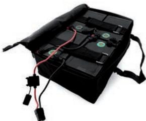
Bleibatterie 12 Ah, Betriebsspannung 48 V (bestehend aus 4 Stück 12 V Blocks), 48 V x 12 Ah = 576 Wh Akkukapazität. Abmessungen 315 mm x 205 mm x 105 mm, zyklentfest. Ersatzteil passend auch für andere Elektro Scooter mit 48 V Betriebsspannung. Lieferung erfolgt inkl. praktischer Tragetasche, Gewicht 17,68 KG.
