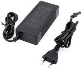
Schnellladegerät für Lithium Ionen Akkus, 24 V Betriebsspannung, Eingang/Input: 100 V - 240 VAC 50/60 Hz, Ausgang/Output: DC 29 V - 4 A, DCJ 5.5 Stecker mit integrierter LED-Anzeige und Auto-Abschaltfunktion (rot=ladend; grün=fertig geladen), Maße: ca. 17 cm x 7 cm x 3 cm, Gewicht: 600 g, Kabellänge: 110 cm + 110 cm = 220 cm.
