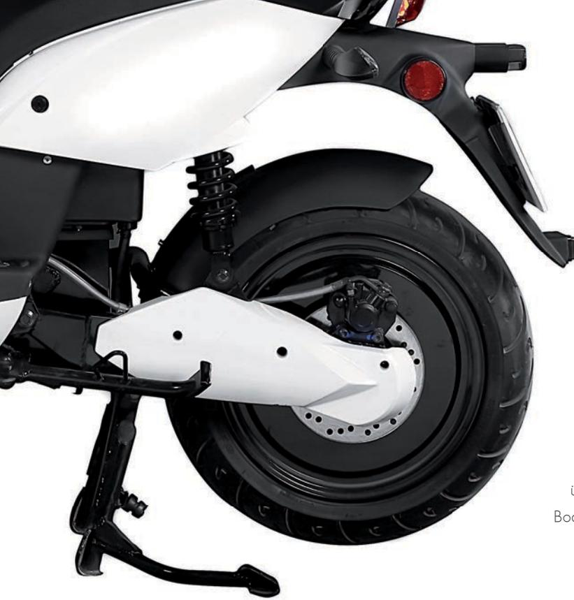
Der SXT SONIX verfügt entsprechend der neuen Richtlinie selbstverständlich auch über das sog. CBS Bremssystem (kombiniertes Bremssystem, welche beiden Bremsen automatisch und immer gleichzeitig betätigt), sowie auch über eine Warnblinkanlage und On Board Diagnostics (OBD).
